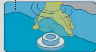
bem lavado para lavar as paredes e o fundo da caixa. Se a caixa for de fibrocimento, substitua o pano úmido por uma escova de fibra vegetal ou de fio de plástico macio novo e lavado. Não use escova de aço, vassoura, sabão, detergente ou outros produtos químicos.
